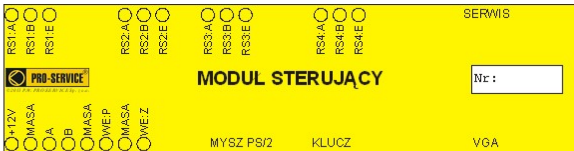
Rys. 9. – Płyta czołowa modułu sterującego centrali modularPAG ® .
