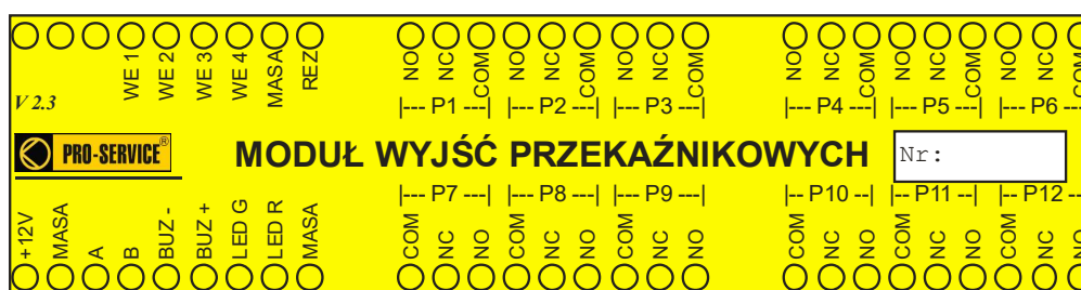
Rys. 11. – Płyta czołowa modułu wyjść przekaźnikowych centrali modularPAG®.
