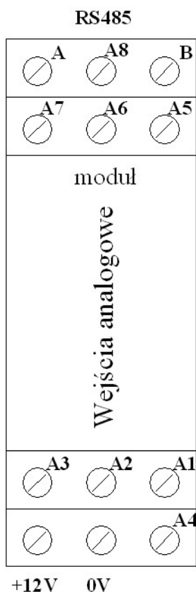
Rys. 15. – Listwy zaciskowe modułu wejść analogowych 4-20mA centrali modularPAG®.
